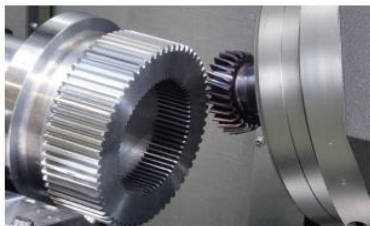
刮削加工 (外径, 内径刮削)
